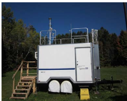
Figure 2 Station de mesure de la qualité de l'air 03049 – Lac-Beauport
