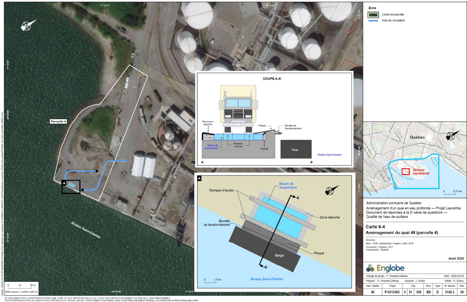
FIGURE 5 : SITE DE TRANSBORDEMENT DES SÉDIMENTS DES BARGES AUX CAMIONS POUR LE DRAGAGE MÉCANIQUE (TIRÉE DE L'ÉTUDE D'IMPACT, FEUILLET 6, CARTE 6-4)
