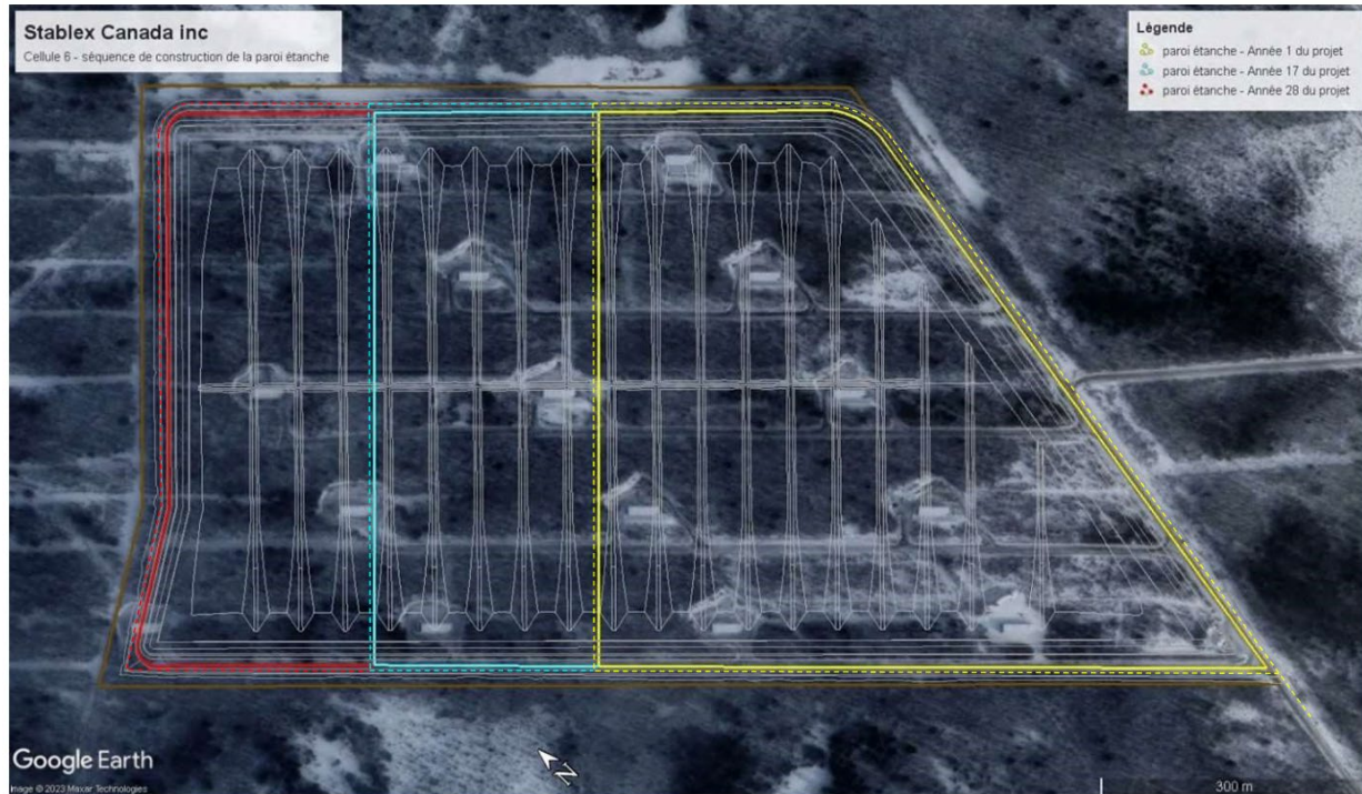
FIGURE 7 : PHASES D'AMÉNAGEMENT DE LA PAROI ÉTANCHE ET DE LA DIGUE PÉRIPHÉRIQUE DE LA CELLULE N° 6 PROJETÉE
