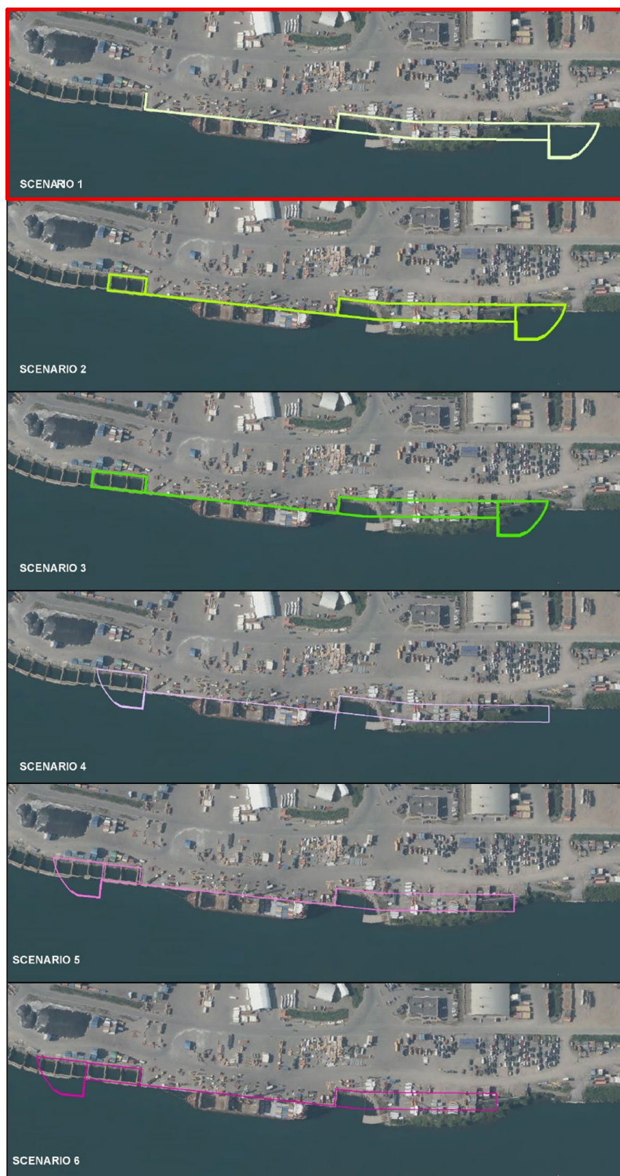
FIGURE 6 : SCÉNARIOS D'EMPLACEMENT POUR L'AGRANDISSEMENT DU QUAI
