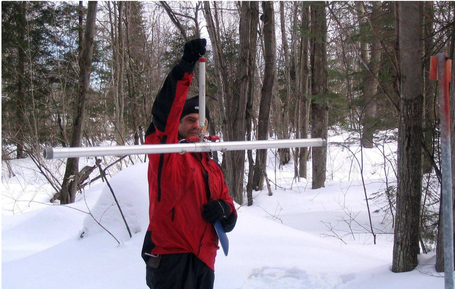
Figure 8.2 Équivalent en eau de la neige – Mesure lorsque l'épaisseur de la neige au sol du site est supérieure à 25 cm
