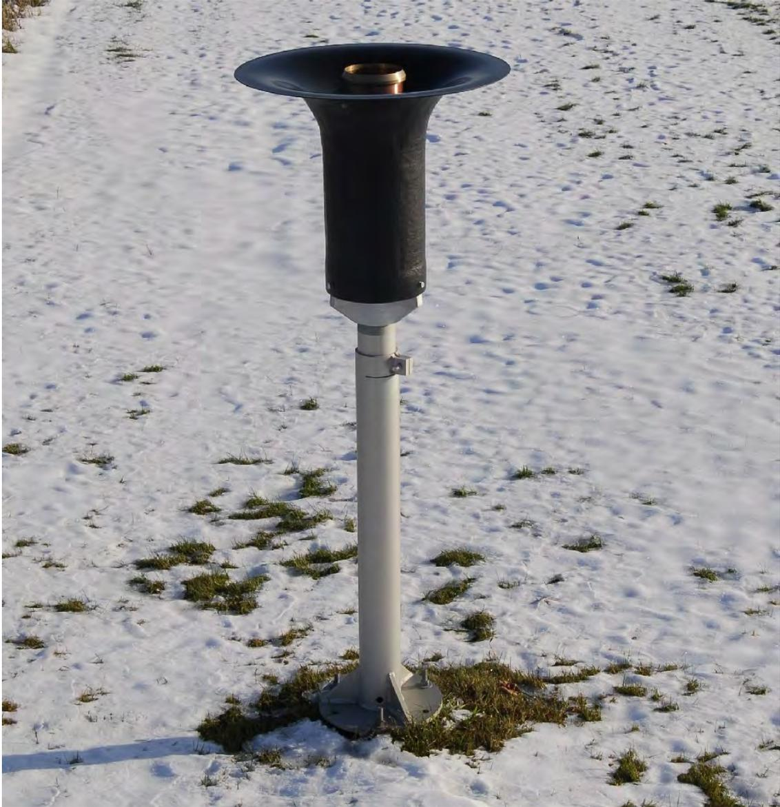
Figure 7.9 Nivomètre à bouclier de Nipher
