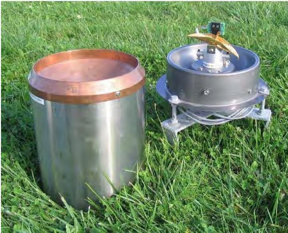
Figure 7.5 Pluviomètre à augets basculeurs
