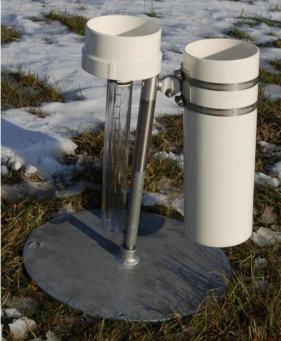
Figure 7.1 Pluviomètre séparé en ses composantes
