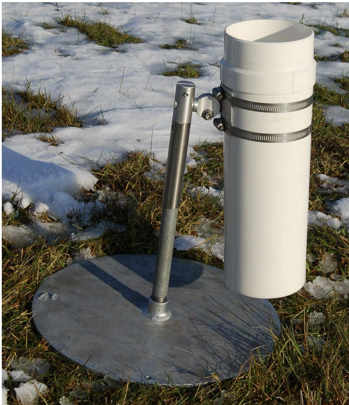
Figure 7.2 Pluviomètre en position
