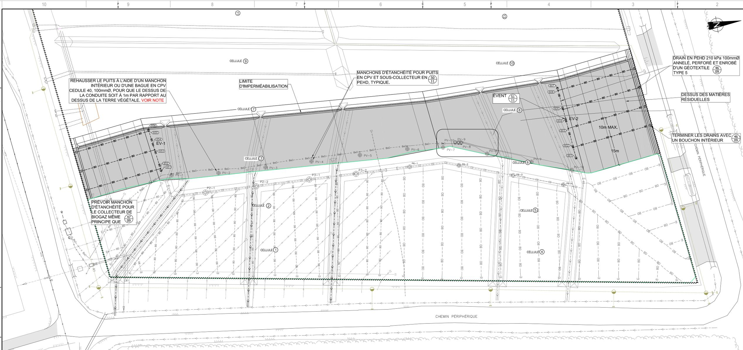
REHAUSSER LE PUIS À L'AIDE D'UN MANCHON INTÉRIEUR OU D'UNE BAGUE EN CPV CEDULE 40, 100mmØ, POUR QUE LE DESSUS DE LA CONDUITE SOIT À 1m PAR RAPPORT AU DESSUS DE LA TERRE VÉGÉTALE. VOIR NOTE
