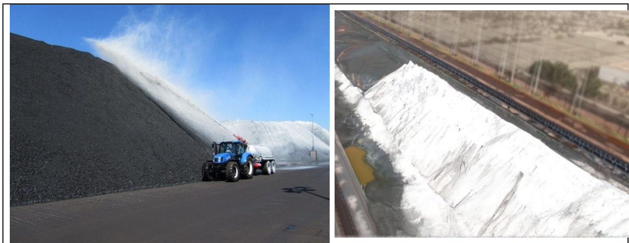
Figure 23 Recouvrement cellulosique de piles de minerais
