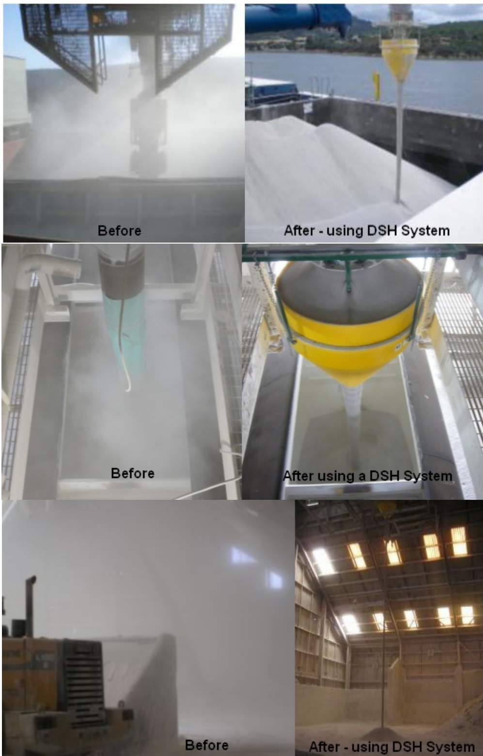
Figure 22 Trémie de suppression de poussière
