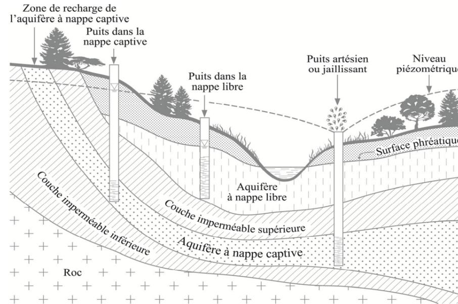
**Figure 10** Schéma hydrologique conceptuel
