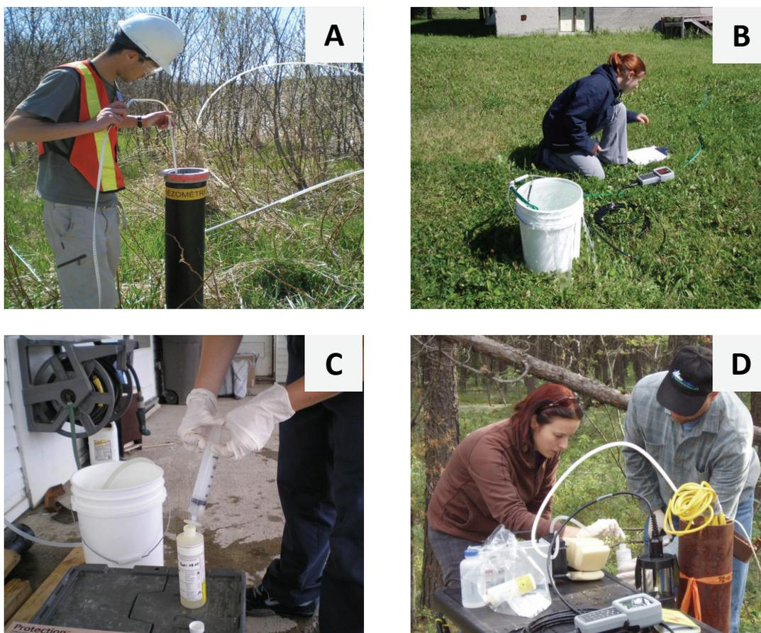
**Figure 3.3 : Photos de la campagne d'échantillonnage des puits privés:** A- mesure du niveau piézométrique; B- analyse des paramètres in situ; C- échantillonnage d'un puits privé; D- échantillonnage d'un piézomètre municipal.
