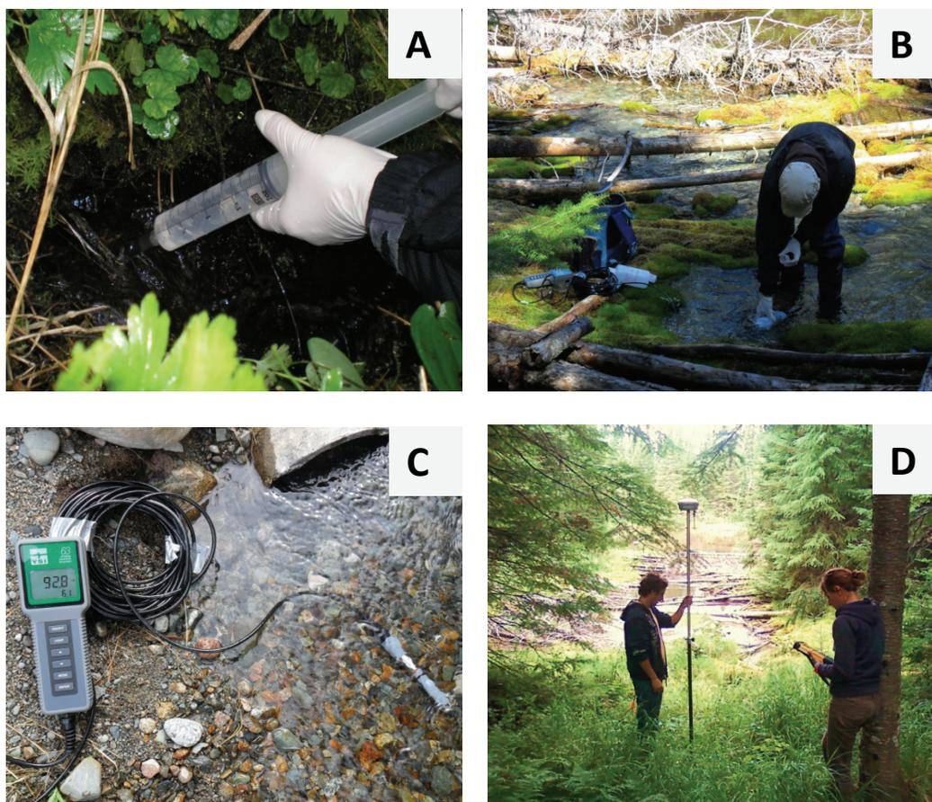
Figure 3.10 : Photos des travaux de terrain de caractérisation des sources : A- échantillonnage d'une source; B- collecte d'eau; C- mesure de paramètres in situ; D- arpentage.
