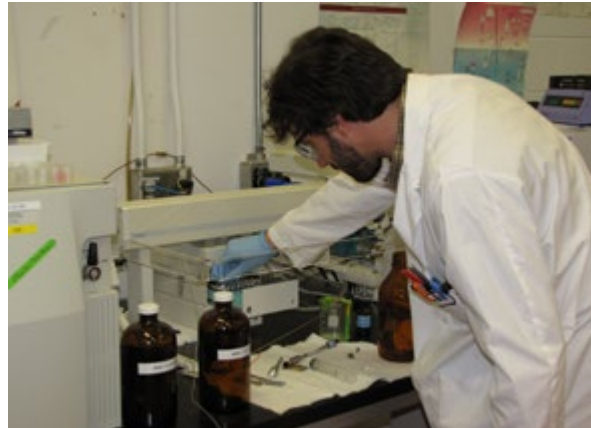
Analyse des pesticides dans l'eau par chromatographie liquide couplée à la spectrométrie de masse en tandem.
