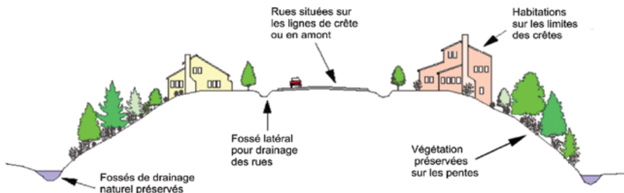
Figure 4.9 Préservation de la topographie naturelle du site.
