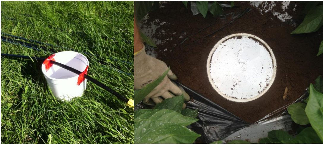
Figure 10. Exemple de montage pour la mesure d'irrigation par goutte-à-goutte (photos : Carl Boivin, IRDA)
