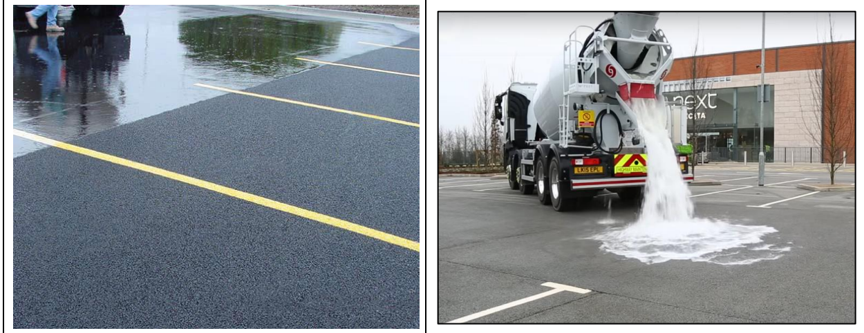
Figure 19-21. Démonstration des propriétés drainantes de l'asphalte poreux
