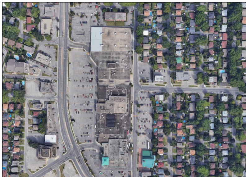
Figure 19-2 Exemple d'un secteur commercial ayant une imperméabilisation de près de 100%, adjacent à un secteur résidentiel, ayant une imperméabilisation entre 45 % et 65 %. Ces secteurs sont desservis par un système d'égout de type unitaire sous le boulevard de cette municipalité québécoise.
