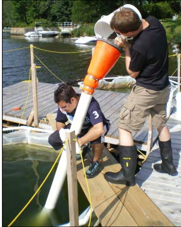
Figure III-5 Dépôt d'une couche de calcaire avec un tuyau verseur Source : Bourget et al. (2011)
