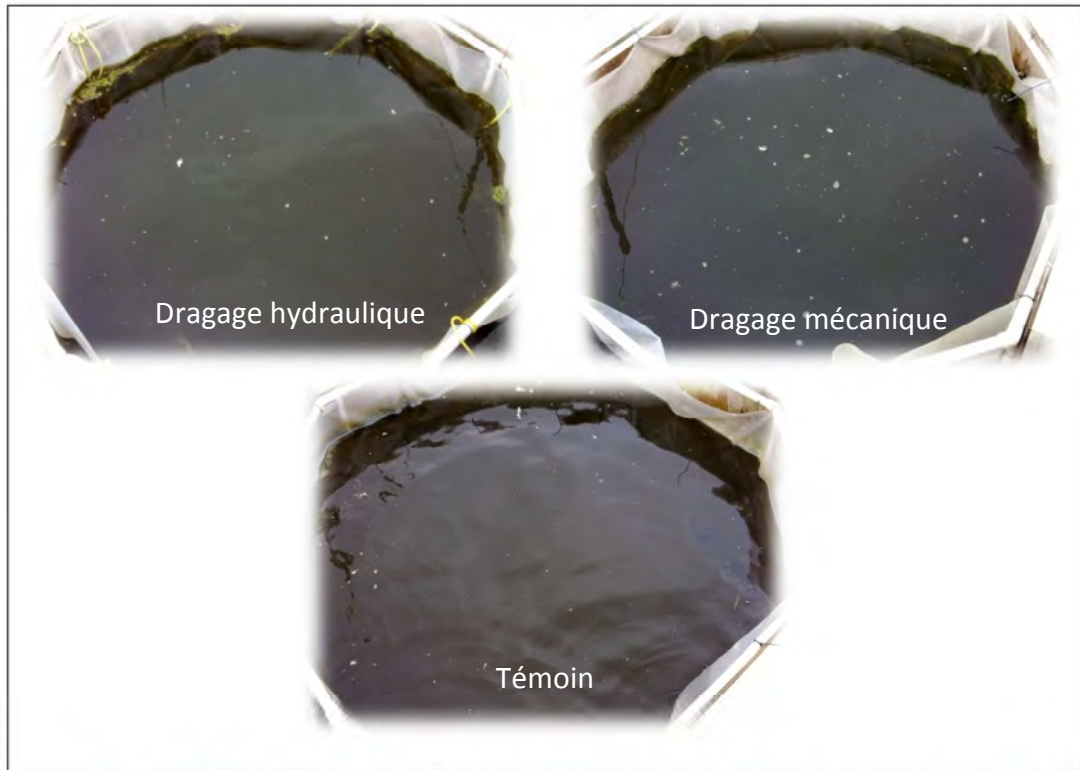
Figure IV-4 Coloration de l'eau des enclos 30 jours après le début des essais du volet II
