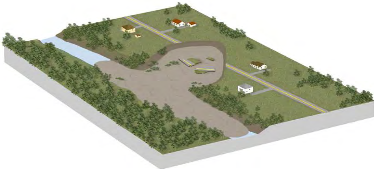
FIGURE 3. GLISSEMENTS DE TERRAINS FORTEMENT RÉTROGRESSIFS.
