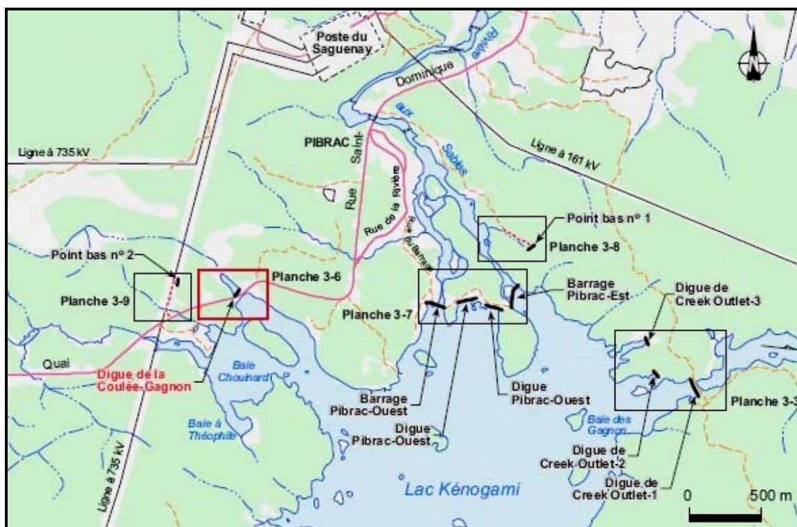
FIGURE 5 : LOCALISATION DES OUVRAGES DE RETENUE EXISTANTS, DES POINTS BAS ET DES ROUTES PRINCIPALES DU SECTEUR NORD DU LAC KÉNOGAMI (TIRÉE DE L'ÉTUDE D'IMPACT, HYDRO-QUÉBEC, 2002C)
