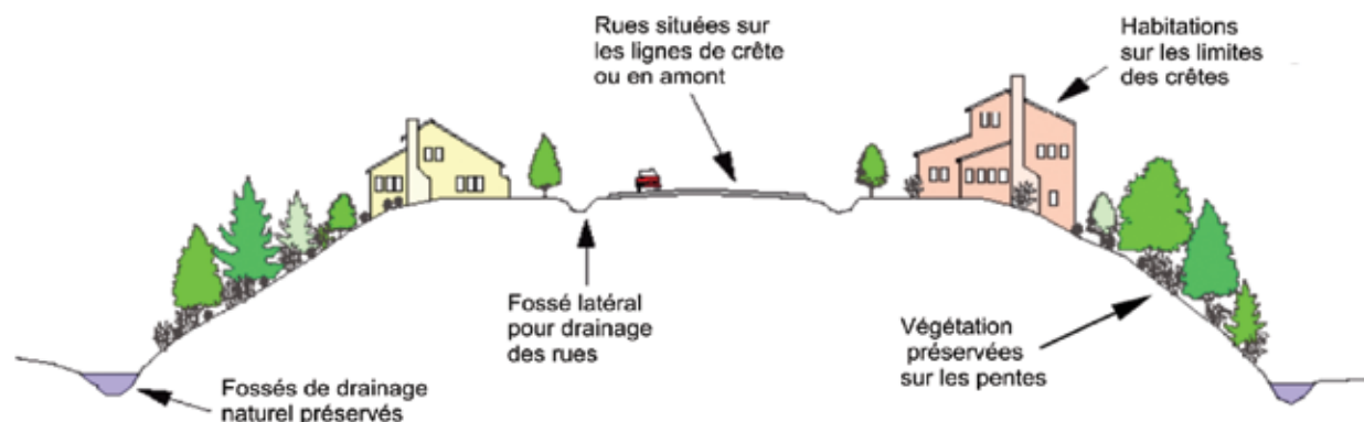
Figure 4.9 Préservation de la topographie naturelle du site.
