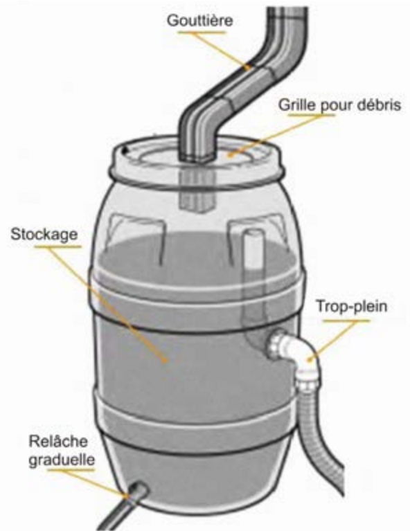
Figure 11.19 Composante d'un système avec baril pour le stockage.
