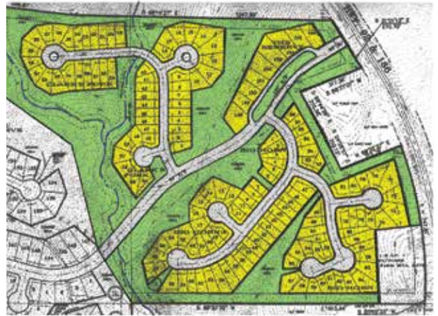
Figure 4.10 Exemple d'aménagement avec des pentes naturelles fortes.
