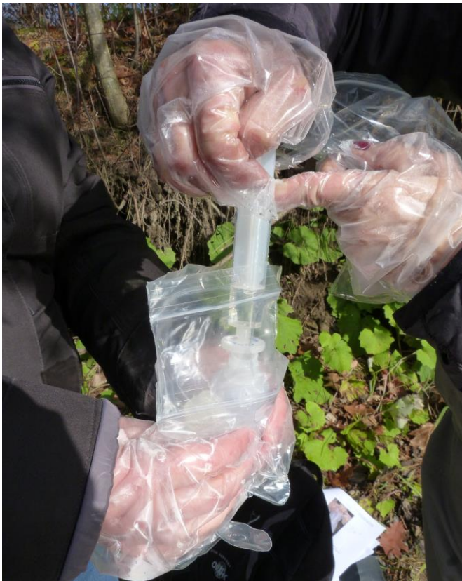
Figure 14. À l'intérieur des sacs, le préleveur filtre 20 ml d'eau de surface dans la bouteille de conservation de 60 ml acidifiée.
