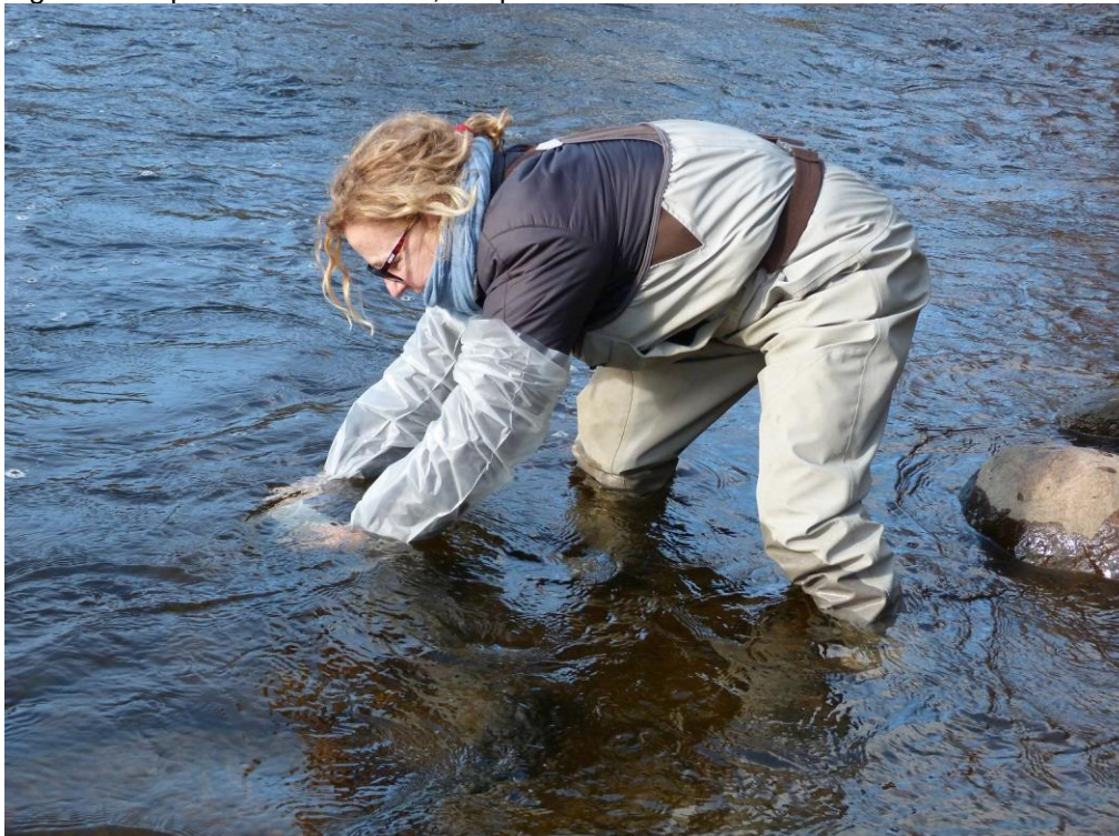
Figure 2. Le préleveur débouche, remplit et referme la bouteille de 250 ml sous l'eau.
