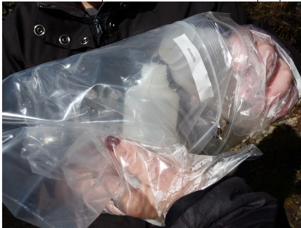
Figure 6. Le préleveur referme rapidement le bouchon de la bouteille de conservation ainsi que les deux sacs.
