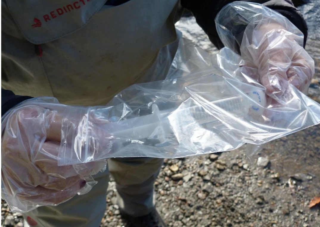
Figure 10. Le préleveur expulse l'eau ultrapure contenue dans la seringue.
