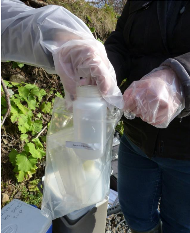
Figure 2. Le préleveur débouche, remplit et referme la bouteille de 250 ml sous l'eau.
