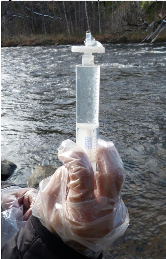
Figure 10. Le préleveur expulse l'eau ultrapure contenue dans la seringue.
