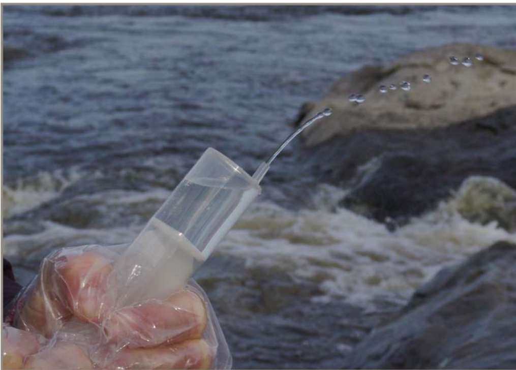
Figure 9 Le préleveur rince une dernière fois la seringue avec de l'eau ultrapure, il élimine l'air et conserve 50 ml d'eau.
