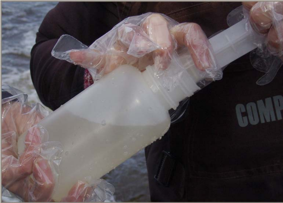
Figure 8 Le préleveur rince trois fois la seringue avec de l'eau ultrapure.
