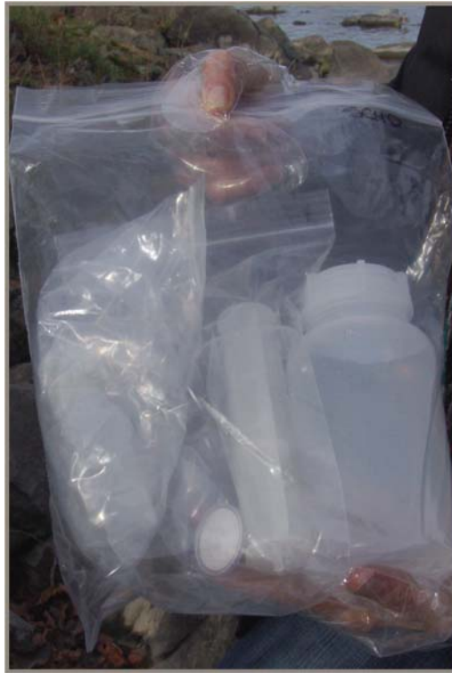
Figure 6 L'assistant retire l'ensemble pour les métaux dissous de la petite glacière.
