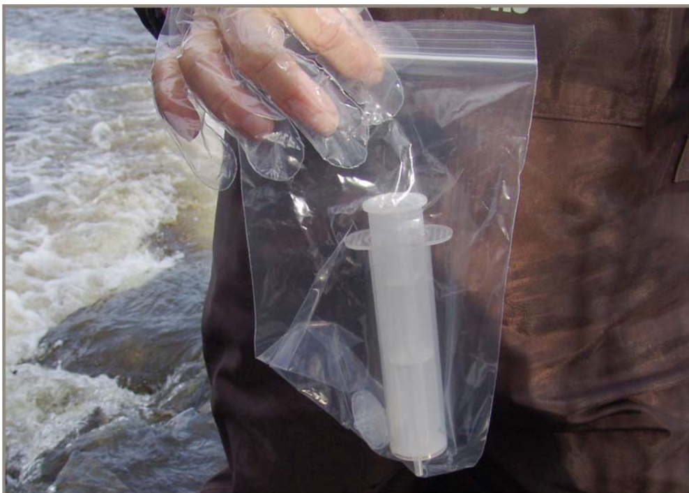
Figure 7 Le préleveur ouvre le sac contenant la seringue et le filtre qui est dans l'ensemble pour les métaux dissous.
