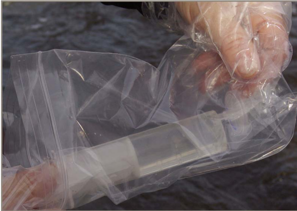
Figure 10 À l'intérieur du sac, le préleveur installe le filtre au bout de la seringue.
