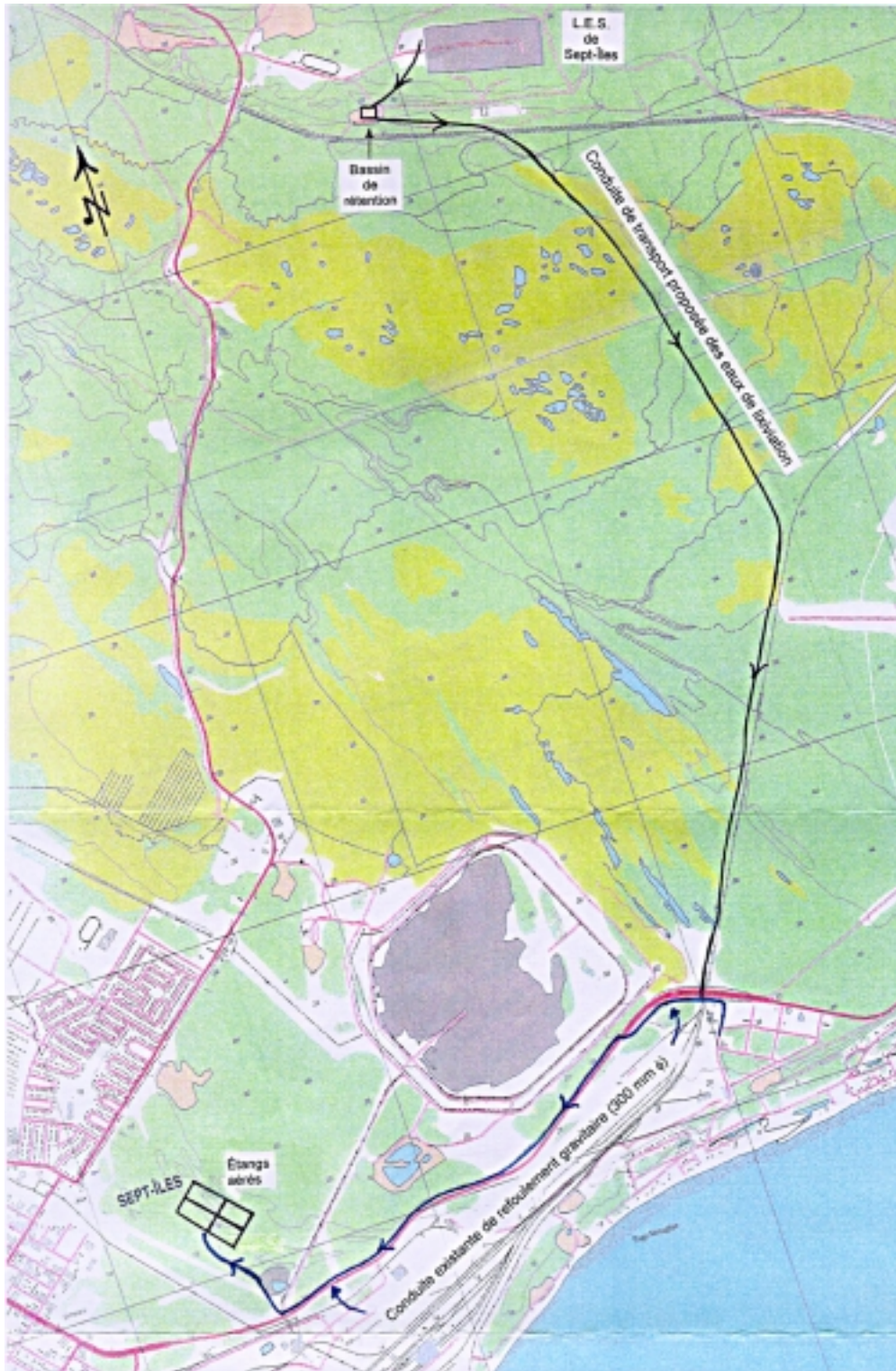
Figure 2 : Conduite de transport des eaux de lixiviation, LES - étangs aérés, Sept-Îles
