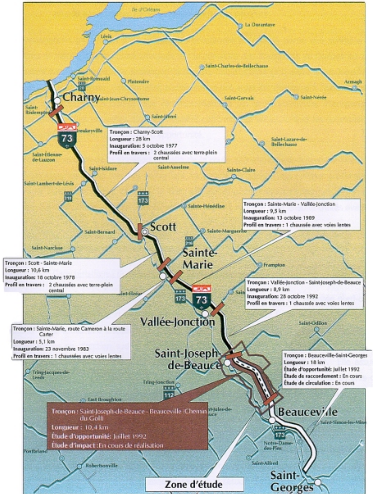
Figure 1 : Résumé des diverses étapes réalisées dans la construction de l'autoroute 73
