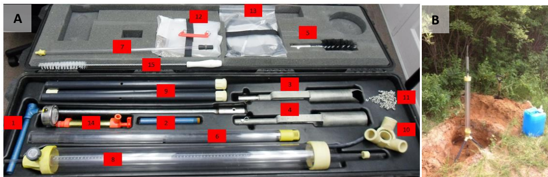
Figure 3.8.2.1 Composantes et installation du perméamètre de Guelph
