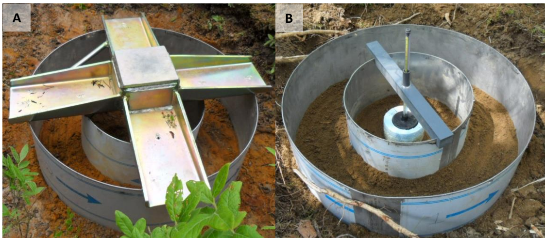
Figure 3.9.2.1 Composantes et installation de l'infiltromètre à double anneau
